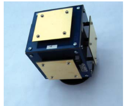
Die isotrope Sonde ‚3D-EFM‘ ist ein hochempfindlicher Sensor, der über unterschiedliche Filtereinstellungen verfügt. Damit lässt sich ein Frequenzbereich von 10 bis 100 kHz abdecken.
